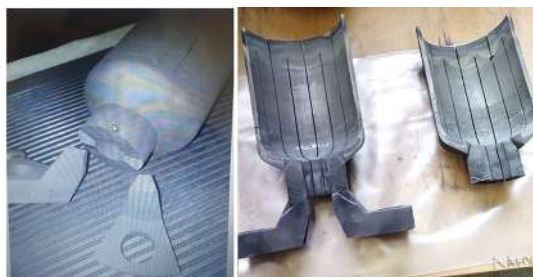
Рис. 3. Разрушение графитового нагревателя через неделю после попадания большого количества паров скандия
