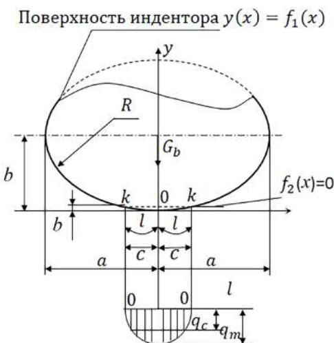
Рис. 2. Схема контакта индентора с упрочняемой поверхностью
